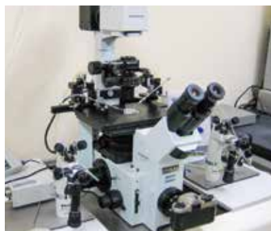
遺伝子組換え動物作製のための マイクロインジェクション装置
